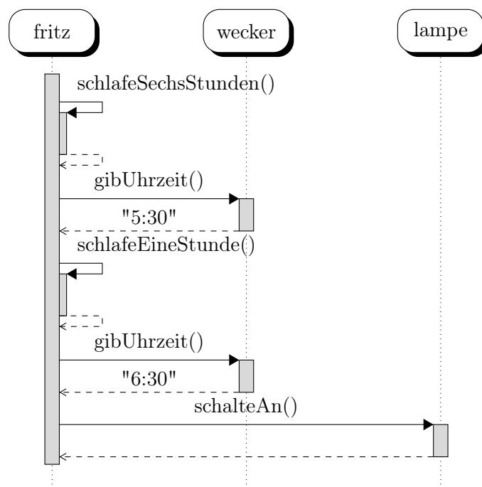
Der Ablauf der Aktionen zwischen Clients und Server wird in einem Sequenzdiagramm verdeutlicht, bei dem die Pfeile schräg nach unten verlaufen. Auch diese werden mit der entsprechenden Aktion versehen. Rückmeldungen können nur durch Aktionen in Gegenrichtung gegeben werden.
